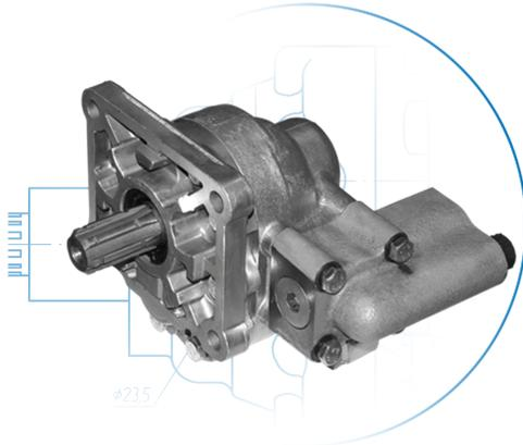
Насос шестеренный с регулятором расхода и предохранительным клапаном НШ32МП-0 предназначен для нагнетания рабочей жидкости в гидросистему рулевого управления автомобилей, тракторов, сельскохозяйственных и других машин. Состоит из шестеренного насоса серии "Master" рабочим объемом 32 см<sup>3</sup>, клапана регулятора расхода и предохранительного клапана.
